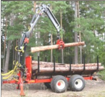
Alle Hydraulikzylinder sind oberhalb des Auslegers angebracht und alle Schläuche verlaufen im Inneren des Auslegers, um sie vor Schäden durch Baumstämme zu schützen. Der Zylinderschutz verringert die Bruchgefahr und Betriebskosten.
