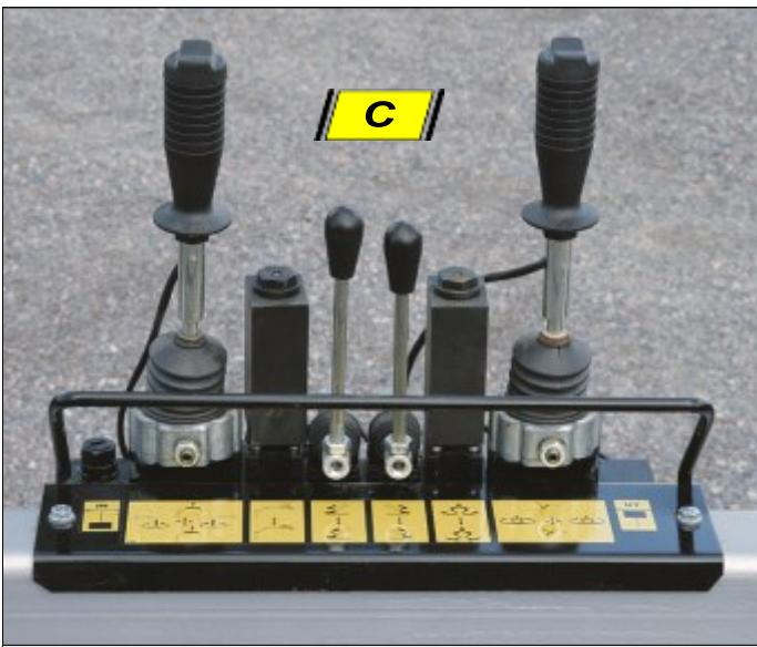
8-Bank-Steueranordnung mit 2-Hebel-System und elektrischer Steuerung des Auslegers sowie Funktionen zum Öffnen und Schließen des Greifers. Umschalter für diese beiden Funktionen befinden über den langen Hebelen. Siehe **C oben**.
