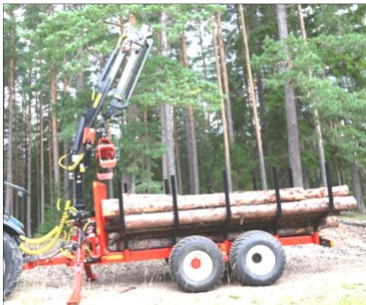
Das Komfortgelenk von K.T.S. ermöglicht es somit, die Holzstämme direkt vom Boden für das Beladen auf den Anhänger zu greifen, ohne die Stämme erneut greifen zu müssen. Dies erleichtert auch die Bedienung des K.T.S.-Krans. Sie können auch Holz in der Nähe des Kopfteils erreichen.
