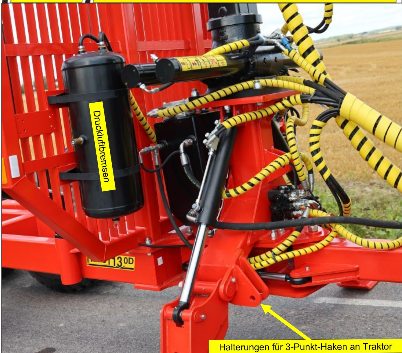
Die Verbindung zwischen 3-Punkt-Adapter und Rückewagen ist ein besonders wichtiger Punkt im Hinblick auf das Abstützen schwerer Lasten. Es ist wichtig, dass nach mehrjähriger Verwendung kein Verschleiß auftritt. Unser 3-Punkt-Adapter ist deshalb durch acht M20-Bolzen paarweise sicher am Rückewagen befestigt. **Die Verwendung von Bolzen anstelle von Stiften schließt die allmähliche Entstehung von Verschleiß aus.**
