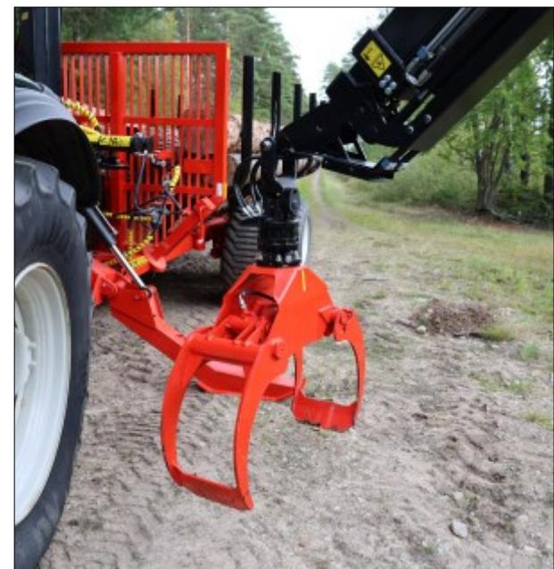
Das Komfortgelenk ermöglicht das Erreichen von Holz in der Nähe des Rückwagens.
