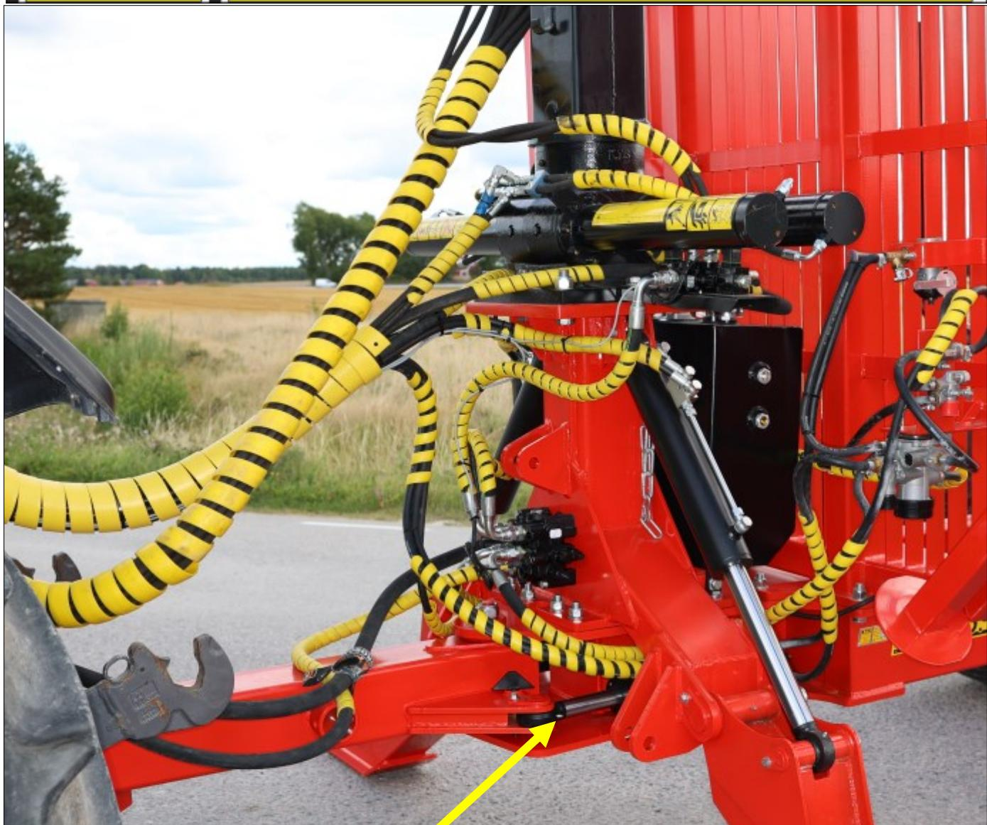
Die Lenkzylinder des Rückewagens sind **hervorragend gegen Beschädigungen geschützt**: Die Bodenplatte schützt die Unterseiten beider Zylinder. Das Risiko für Schäden ist somit geringer und die Betriebskosten fallen niedriger aus. K.T.S-Rückewagen verwenden standardmäßig zwei Zylinder für die Rückewagenlenkung.
