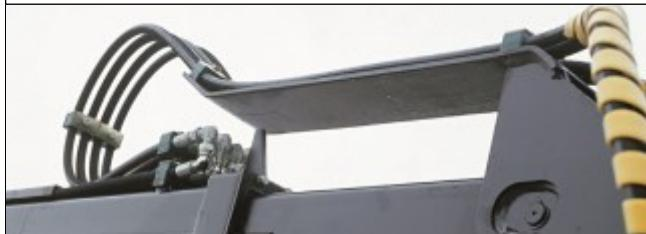
Der innere Abschnitt des Teleskopauslegers an dem 8,6-m-Kran mit doppelter hydraulischer Verlängerung verläuft in verstellbaren Gleitlagern, um das Spiel zu verringern und die Festigkeit zu erhöhen. Die Konstruktion entspricht einem Rückekran. Auf diese Weise kann K.T.S die Funktionsfähigkeit sicherstellen.
