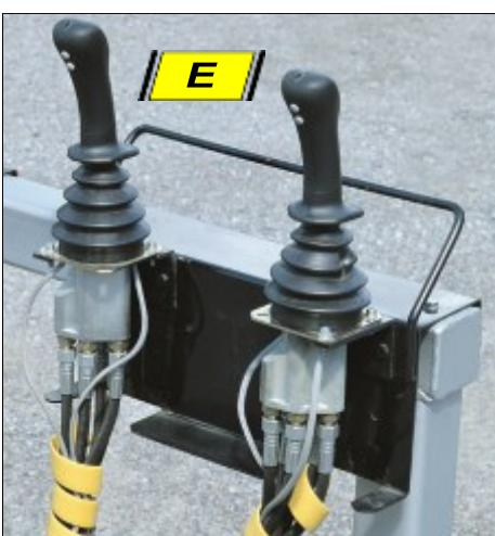
8-Bank-Steueranordnung mit 2-Hebel-System und elektrischer Steuerung des Auslegers sowie Funktionen zum Öffnen und Schließen des Greifers. Umschalter für diese beiden Funktionen befinden über den langen Hebelen. Die kurzen mittigen Hebel steuern die Stützbeine. Der gesamte Kran wird ebenfalls über zwei Hebel unter Verwendung dieser Steuerhebelanordnung gesteuert.
