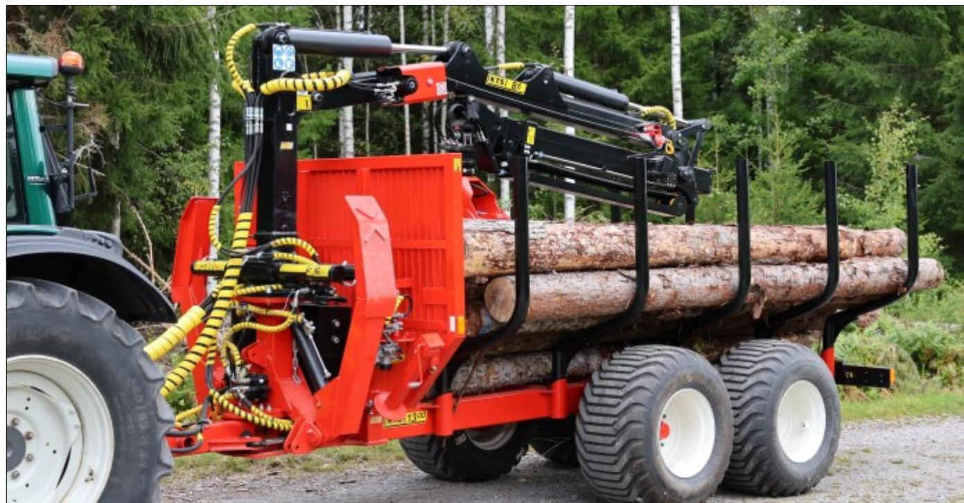
Mit einem 13-Tonnen-Rückewagen von K.T.S können Sie sicher in Forstgebieten arbeiten. Die Festigkeit von Anhängern und Kränen wird unter Verwendung der Finite-Elemente-Methode (FEM) berechnet. Das Anhängergewicht verringert sich, wenn Materialien und Verstärkungen an geeigneten Stellen platziert werden.
