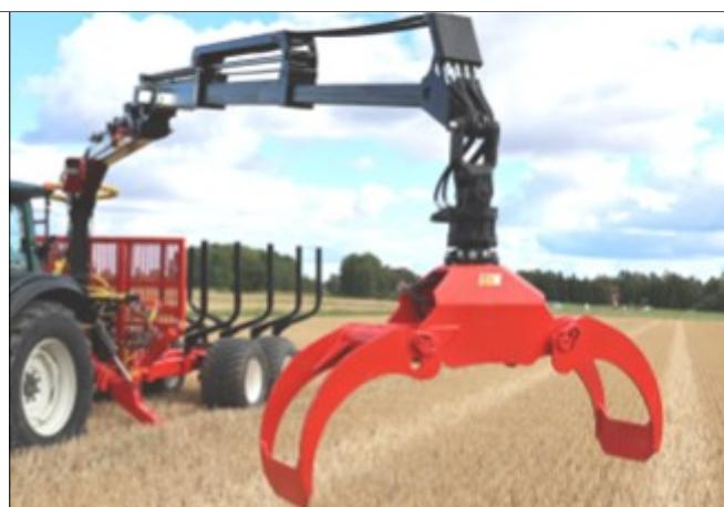
Rotator mit 6 Tonnen, mit M16-verschraubtem Rotator, Greifarm aus Hardox®
