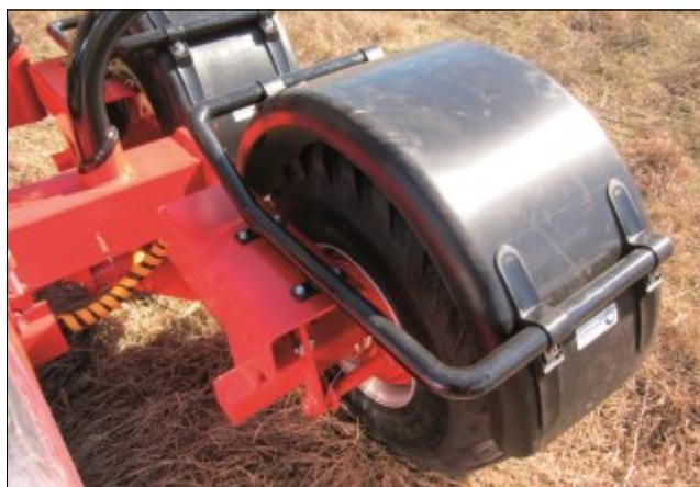
Kotflügel können optional an K.T.S. Rückewagen installiert werden.
