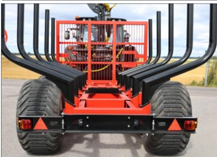
Der zentrale Rahmen und die Gehäuse sind aus Baustahl gefertigt und die Festigkeit wird anhand der FEM-Methode berechnet
