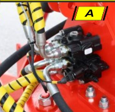
Das **K.T.S-Leichtgewichtspaket** besteht aus zwei seriell verbundenen Ventilblöcken und ist nur halb so groß und schwer wie ein üblicher Ventilblock. Ein Ventilblock mit 2 Hebeln ist im Fahrerhaus zur Steuerung von Schwenkbewegungen, Auslegern und Rotator montiert. Siehe **A oben**.
