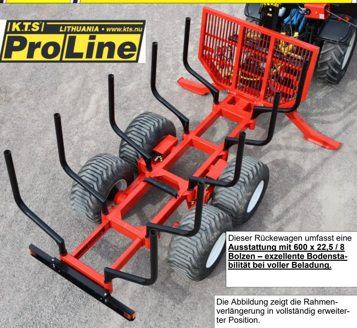
Der K.T.S-Rückewagen, 13,0 t, mit doppeltem Rahmen kann mit einer Rahmenverlängerung ausgestattet werden, welche das Arbeiten mit unterschiedlich langen Hölzern vereinfacht. Der Pfeil zeigt den Verriegelungsmechanismus.
