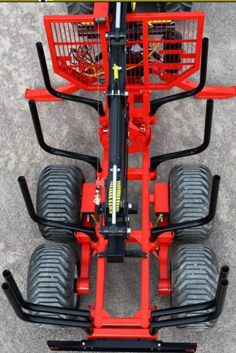
Es wirken enorme Kräfte auf das Fahrgestell, die Zugdeichsel, die Achsen und Räder, wenn der Rückewagen voll mit grob geschnittenen und schweren Holzstämmen beladen ist. Das Schwenkgehäuse und die Stützbeine sind beim Hantieren mit großen Baumstämmen ebenfalls großem Druck ausgesetzt. In diesem **Fall ist es beruhigend wenn Sie sich als Eigentümer darauf verlassen können, dass die Ausrüstung für anspruchsvolle Aufgaben gebaut wurde und auf einer Berechnung mit der FEM-Methode basiert.**
