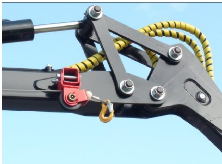
Das **Komfortgelenk** ist ein zusätzlicher Gelenkmechanismus, der den **Bewegungsspielraum erheblich erhöht**, d. h., dass der Kran kann viel näher am Anhänger arbeiten kann. Somit können Sie Holz in der Nähe des Kopfteils erreichen.
