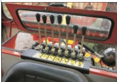
7-Hebel-Steuerung, ein Hebel für jede Funktion. Die kurzen Hebel sind für die Bedienung der Stützbeine vorgesehen.
