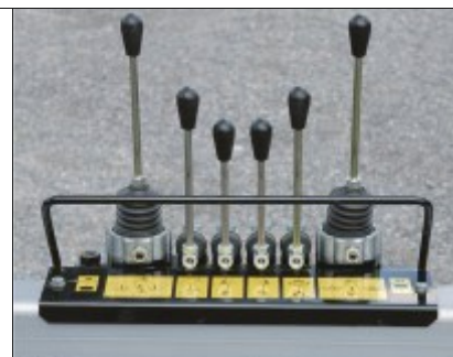
8-Spulen-Steueranordnung mit 2-Hebel-System für die 6,4- bis 6,7- und 7,5-m-Krane, siehe technische Daten. Standard, wenn der Kran mit Hydraulikverlängerung ausgestattet ist.
