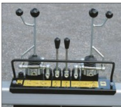
8-Spulen-Steueranordnung mit 3-Hebel-System 'Rentiergeweih' als Sonderausstattung für alle Krane. Mit dieser Hebelanordnung wird der gesamte Kran mittels zweier Hebel bedient.
