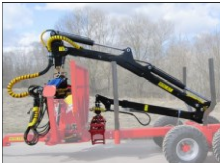
K.T.S-6,7-m-Kran mit Krankomfortgelenk und 1,2-m-Hydraulikverlängerung
