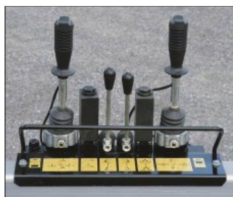
8-Spulen-Steueranordnung mit 2-Hebel-System und elektrischer Steuerung des Auslegers sowie der Greiferöffnungs- und -schließfunktionen, Sonderausstattung für die 6,4- bis 6,7- und 7,5-m-Krane. Umschalter für diese beiden Funktionen oben an den langen Hebeln. Die kurzen Hebel in der Mitte sind für die Bedienung der Stützbeine vorgesehen. Mit dieser Hebelanordnung wird der gesamte Kran ebenfalls mittels zweier Hebel bedient.
