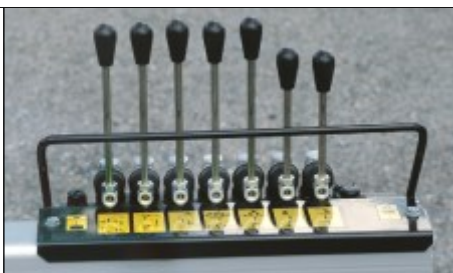
7-Hebel-System, ein Steuerhebel für jede Funktion für die 5,3-m- und 5,4-m-Krane, siehe technische Daten. Die kurzen Hebel sind für die Bedienung der Stützbeine vorgesehen.
