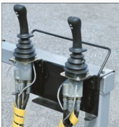
Die Steuereinheit könnte beim Anheben auf den Traktor schwer sein. Daher können unsere Krane mit Niederdruckservo ausgestattet werden. In diesem Fall werden für die Bedienhebel nur dünne Schläuche (siehe Abbildungen 23 bis 24) verwendet. Die Ventileinheit wird dann am Kran befestigt.
