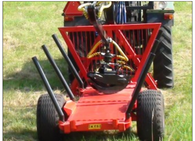
Einachsiger 5,5-Tonnen-Rückewagen mit 5,4-m-Kran
