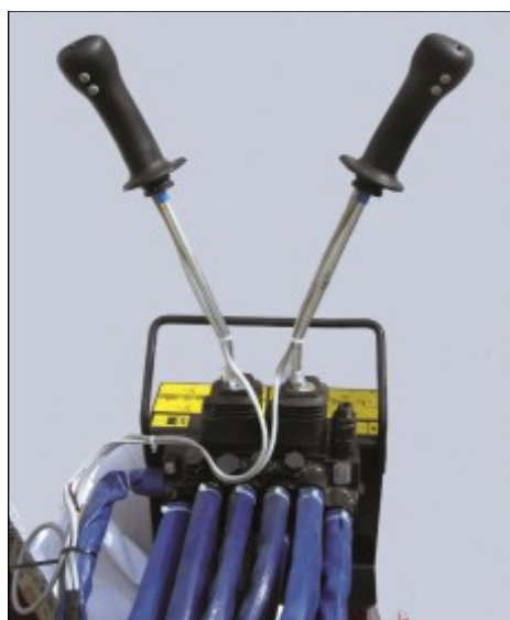
Das K.T.S-Leichtgewichtspaket besteht aus zwei seriell verbundenen Ventileinheiten und ist nur halb so groß und schwer wie eine übliche Ventileinheit. Eine Ventileinheit mit 2 Hebeln ist im Fahrerhaus zur Steuerung von Schwenkbewegungen, Auslegern und Rotator montiert. Der Greifer, die Hydraulikverlängerung und die Stützbeine werden über Tasten an den Hebelgriffen und Kabel zu einem fest am Kran befestigten Ventil gesteuert.
