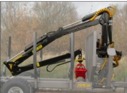
K.T.S-6,4-m-Kran mit Krankomfortgelenk und 1,2-m-Hydraulikverlängerung
