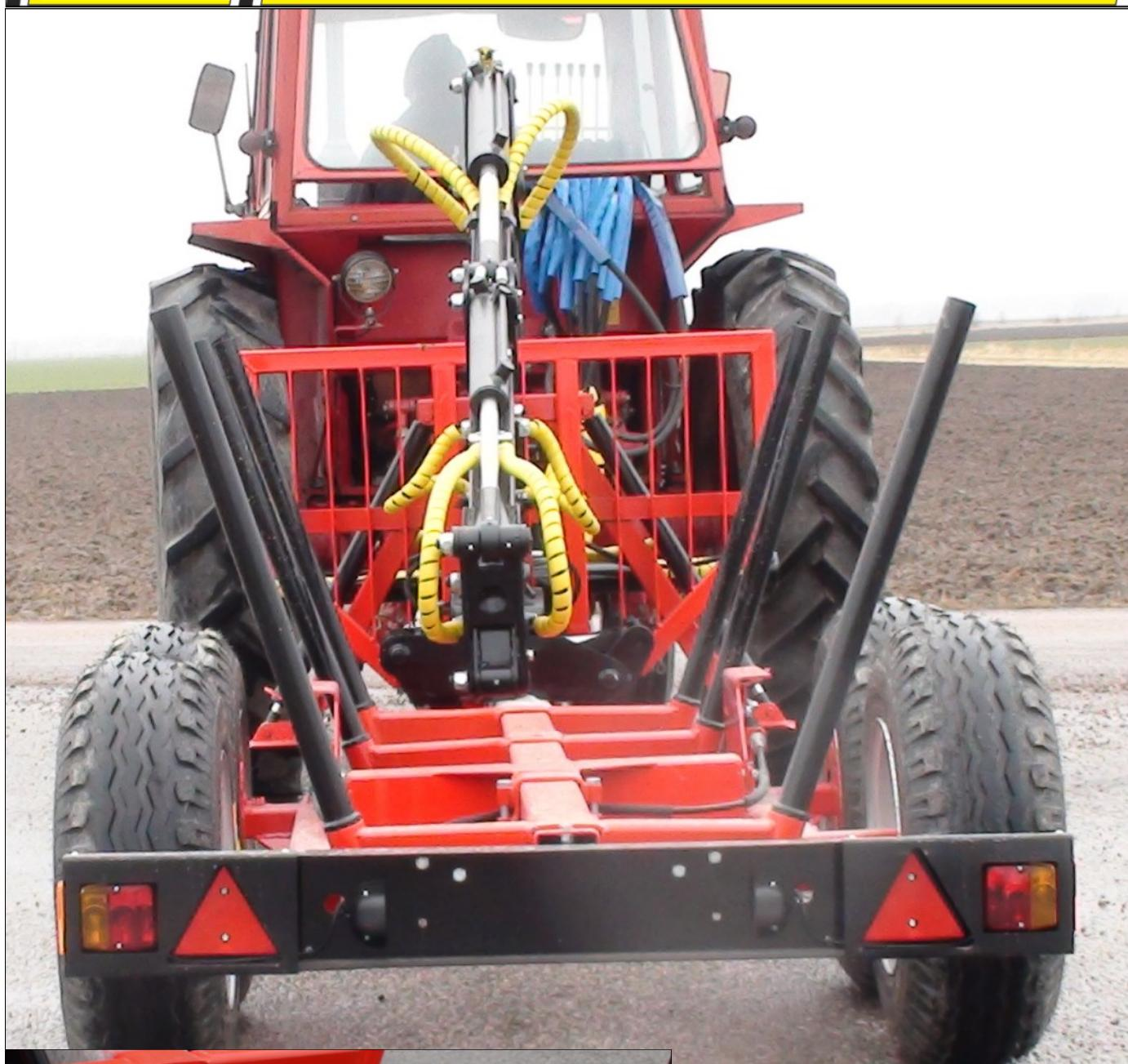
Das Zentrumrohr und die Gehäuse sind aus Baustahl gefertigt und die Festigkeit wird anhand der FEM-Methode berechnet
