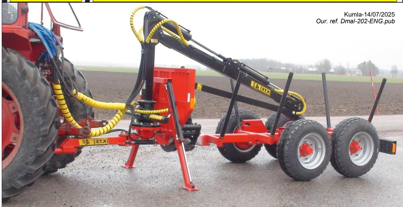
Mit einem 4 Tonnen Rückewagen von K.T.S können Sie sicher in Forstgebieten arbeiten. Die Festigkeit von Anhängern und Kränen wird unter Verwendung der Finite-Elemente-Methode (FEM) berechnet. Das Anhängergewicht verringert sich, wenn Materialien und Verstärkungen an geeigneten Stellen platziert werden.
