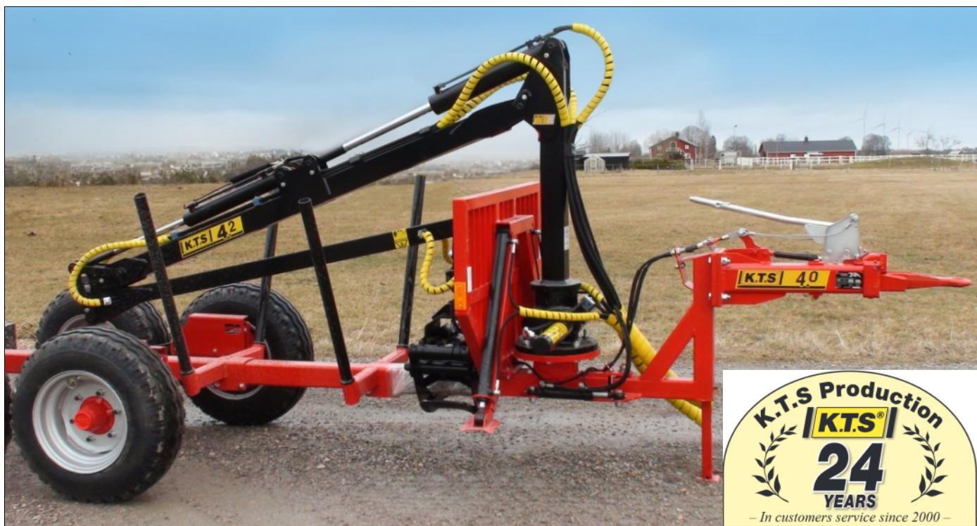
Dieser Rückewagen wurde mit einer hohen Zugdeichsel für den deutschen Markt angepasst. Die Bremsen sind mechanisch und alle sonstige Ausrüstung wird in Übereinstimmung mit der Straßenverkehrsordnung hergestellt.
